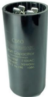
Los condensadores de arranque son usados en motores monofásicos para aumentar el torque de inicio y romper la inercia estática. Los condensadores no trabajan de forma continua, se desconectan cuando el motor llega al 70% de su velocidad.
